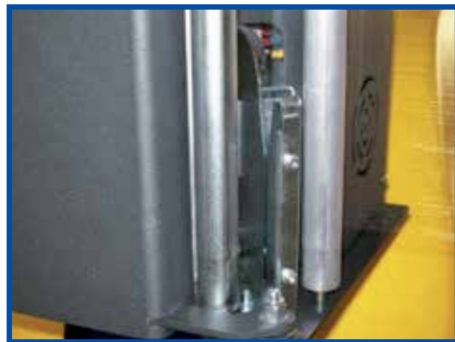
IT_ Sistema di taglio automatico del film a fine ciclo. EN_ Automatic Film cutting device at cycle end. FR_ Coupe automatique du film. DE_ Automatische Folienschneidvorrichtung am Zyklusende. ES_ Sistema automático de corte film con fin de ciclo.
