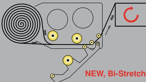
● Sistema di prestiro motorizzato a 3 rulli comandato elettronicamente con rapporti intercambiabili: 150 - 200 - 250%.
