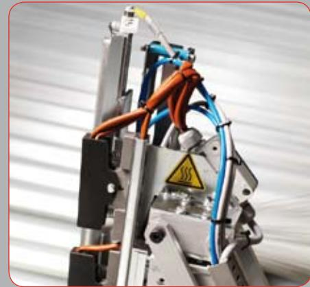
● Sistema a corda: Permette di ridurre l'altezza del film formando un cordone che assicura una più efficiente stabilizzazione del carico.
