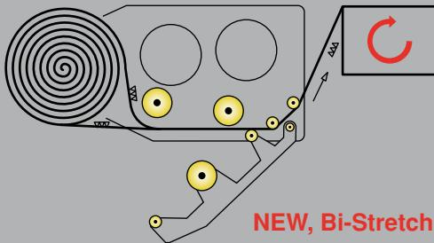
● Sistema di prestiro motorizzato a 3 rulli con 2 motori e variazione continua da 120 a 350% regolabile da quadro comandi.
