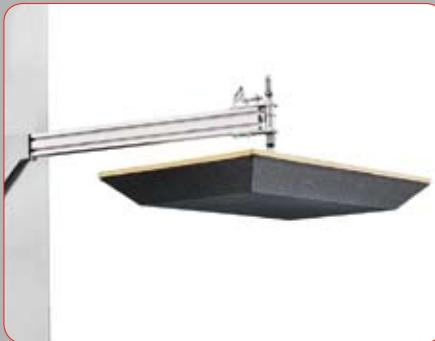
● Sistema saldatura del film estensibile autoregolante per qualsiasi dimensione del pallet.
