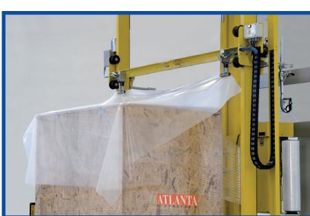
**IT** Dispositivo di copertura ermetica o antipolvere del pallet (Top Cover).
