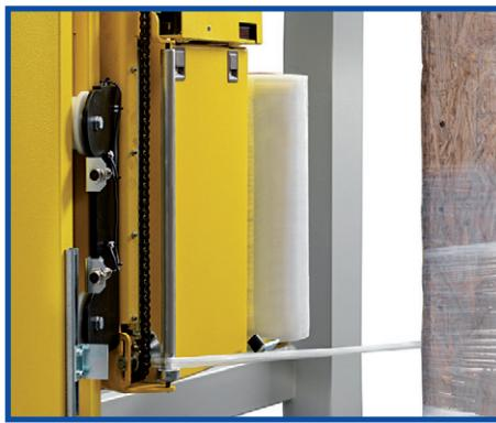
**IT** Sistema a corda: Permette di ridurre l'altezza del film formando un cordone che assicura una più efficiente stabilizzazione del carico.
