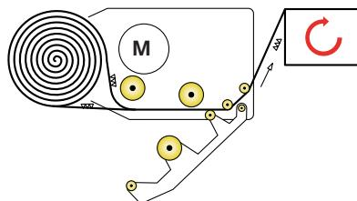
**IT** Sistema di prestiro motorizzato a 3 rulli comandato elettronicamente con rapporti intercambiabili: 150 - 200 - 250%.
