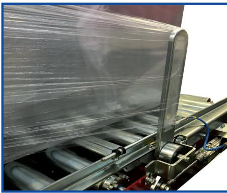
**IT** Saldatura su contrasto per garantire una perfetta saldatura della coda finale del film.
