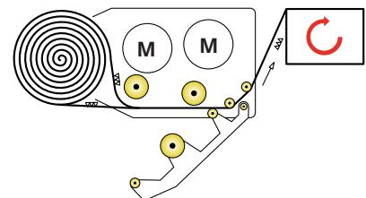
**IT** Sistema di prestiro motorizzato a 3 rulli con 2 motori e variazione continua da 120 a 350% regolabile da quadro comandi.
