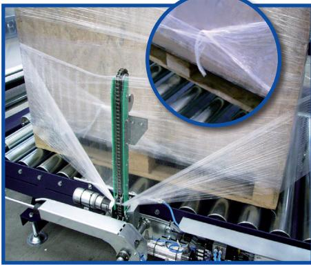
**IT** Sistema pinza taglio del film estensibile con inserimento del lembo finale nell'ultimo avvolgimento di film. Utilizzabile anche con film macroforato.
